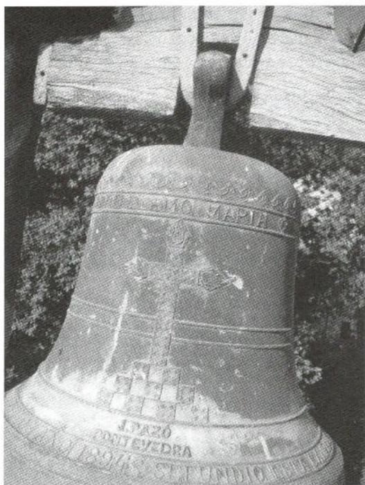
< Campá pequena da igrexa do Salvador de Poio, concello de Poio (Pontevedra), onde se aprecia a greca superior e por debaixo epigrafía entre dous cordóns, a cruz ornamental, interrompida por un par de cordóns, a firma do fundidor e a súa procedencia, así como a data “1894” entre un trío de cordóns (Foto E. Cigoña)
